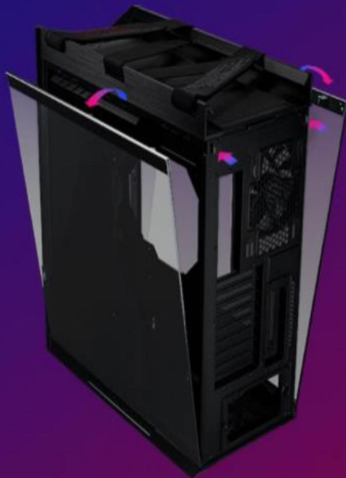
Al pulsar los botones de apertura situados en la parte posterior, puedes acceder al interior del chasis abriendo los paneles laterales hacia abajo. Gracias a las bisagras situadas en la parte inferior, los paneles de cristal templado permanecen apoyados en ángulo hasta que los abres.
