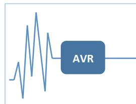
Proporciona voltaje limpio y consistente de CA, regulando automáticamente bajos voltajes y sobre voltajes, cuando el voltaje de entrada tiene fluctuaciones bajas.
