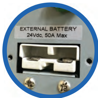
Entrada banco de baterías externas
