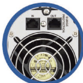
Protección de línea de datos
